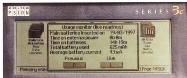
La finestra per monitorare il consumo elettrico della macchina.
